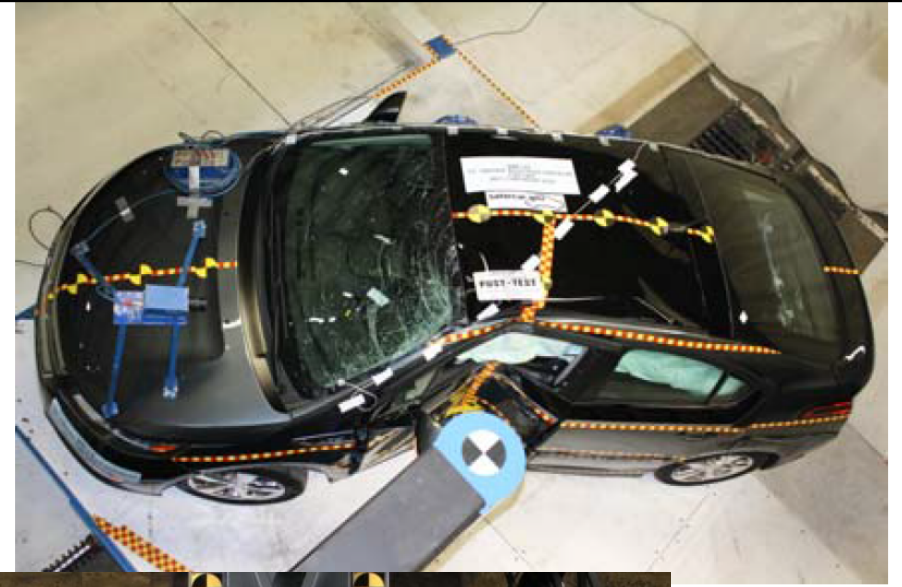
Chevrolet Volt NCAP Pole Test – Post- test
